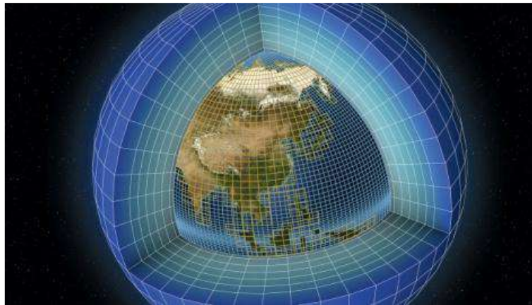
Рис. 3.1.1. Схематичне представлення атмосфери в Моделях Загальної Циркуляції (МЗЦ) або глобальних кліматичних моделях (ГКМ)
