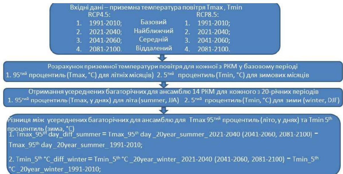
Рис 3.1.6. Алгоритм покрокової обробки даних 14-ти РКМ сценаріїв RCP 4.5 і RCP 8.5 для Tmax 95-го процентилу (літо) та Tmin 5-го процентилу (зима) у кожному вузлі сітки території області
